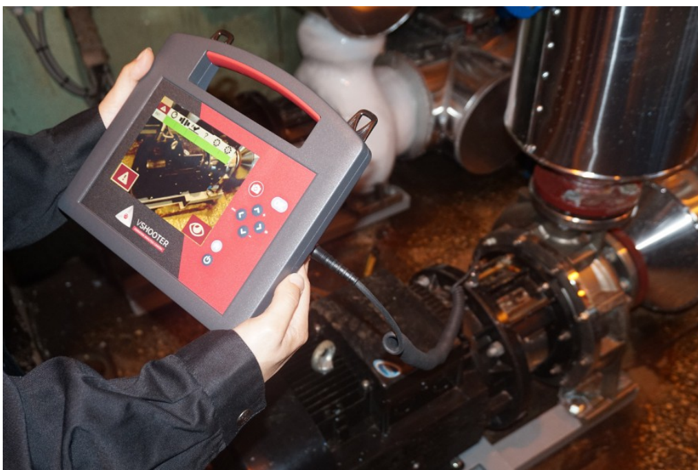
(fot.16 Wynik diagnostyki wibracji na ekranie analizatora wibracji VSHOOTER)
