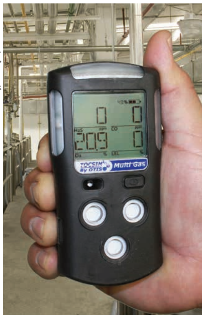
Fot. 1. Przenośny miernik gazów TOCSIN z rejestracją danych pomiarowych dla kilku sensorów jednocześnie
