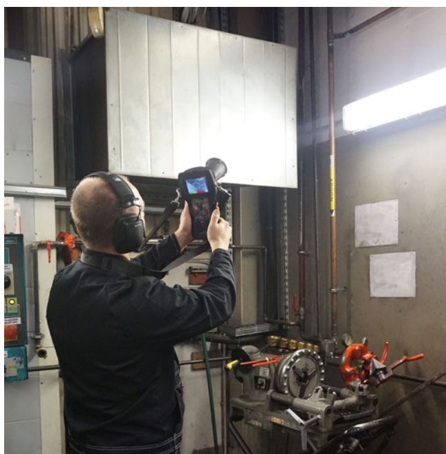
Rys. 3. Dzięki tubie z przodu przyrządu możliwe jest wykrywanie wycieków z odległości bez konieczności stosowania dodatkowych przyrządów, np. sondy parabolicznej
