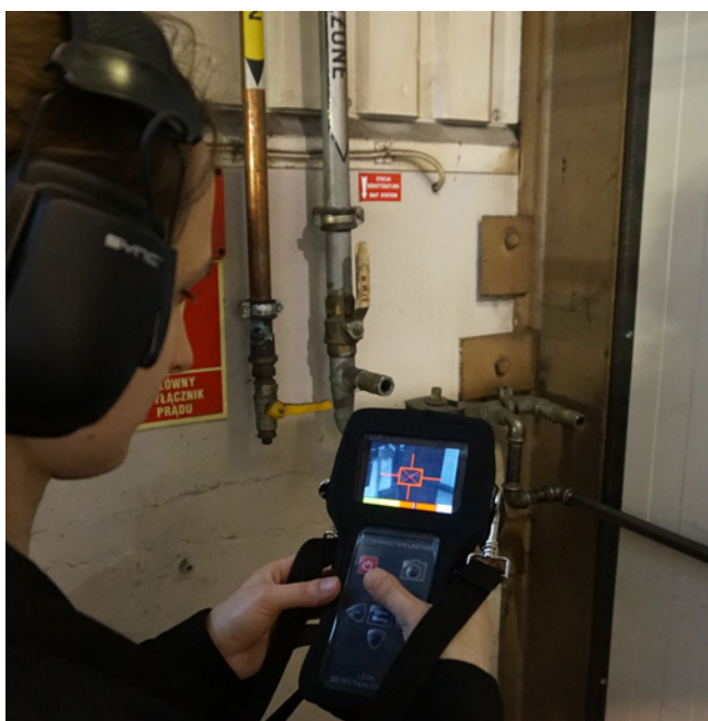
Rys. 2. Kolejne etapy wykrywania wycieku na instalacji. W miarę zbliżania przyrządu do miejsca wycieku wyraźnie widać zmianę wskaźnika
