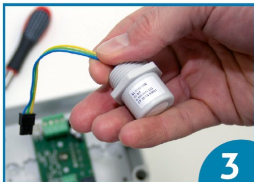
(fot.2 Wymiana sensora w detektorze PolyGard2 dzięki technologii X-Change to tylko kilka ruchów)
