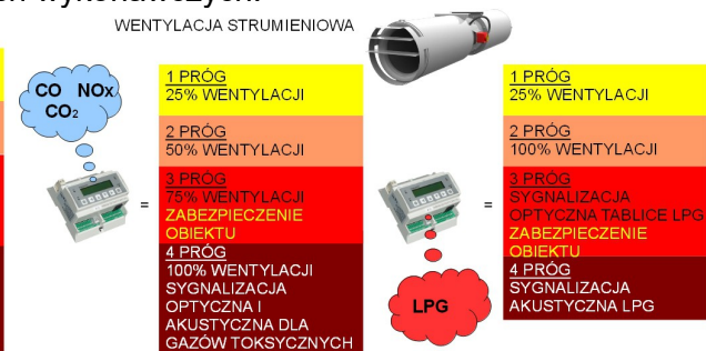
(rys.11 typowe funkcje progów alarmowych przy sterowaniu 1-biegową wentylacją strumieniową)
