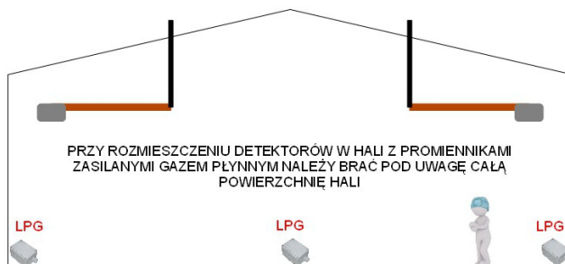
(rys.9 przykładowe rozmieszczenie detektorów propanu-butanu)
