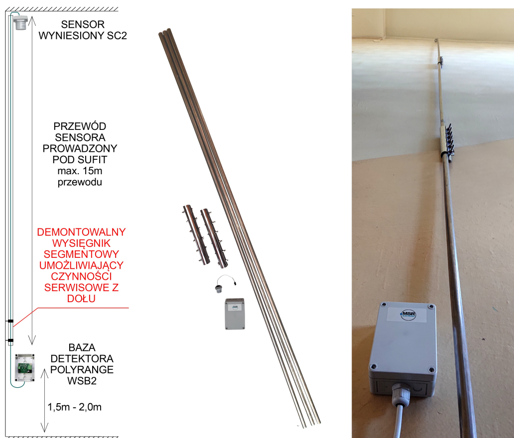
(rys.7 PolyRange to przykład detektora z sensorem wyniesionym. Lekki sensor nie obciąża konstrukcji wysięgnika dzięki czemu można stosować lekkie stopy aluminiowe segmentowe pozwalające na demontaż w pionie przez jedną osobę.)
